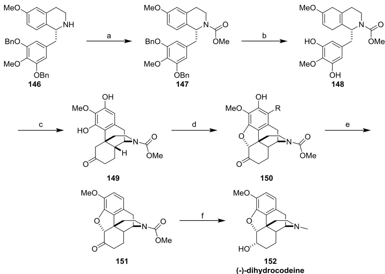
a)  $\text{ClCO}_2\text{Me}$ , THF,  $\text{NEt}_3$  b) Li,  $\text{NH}_3$ , *t*BuOH c) HCl,  $\text{Et}_2\text{O}$ , reflux d)  $\text{CuBr}_2$ ,  $\text{CHCl}_3$ / EtOAc; 0.5M NaOH e)  $\text{Tf}_2\text{O}$ , pyridine; cat.  $\text{Pd}(\text{Ph}_3)_4$ ,  $\text{HCO}_2\text{H}$ ,  $\text{NEt}_3$ , DMF 60°C f) DIBAL, THF
